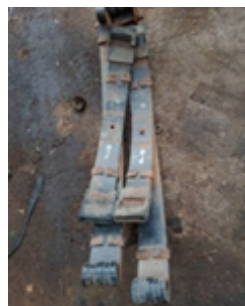
Gambar 5. Baja skrap pegas daun SUP 9 sebagai spesimen uji
