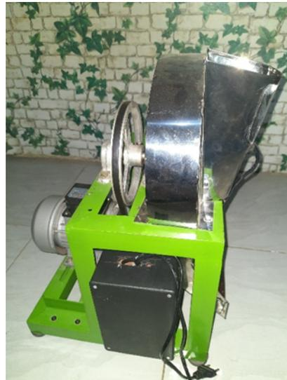
Gambar 3. Alat pemotong Bawang Merah Otomatis Berbasis Arduino Uno dan Sensor Ultrasonic
