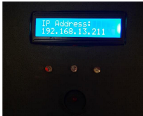
Gambar 3. Indikator Terhubung Hotspot Smartphone ke ESP-32
