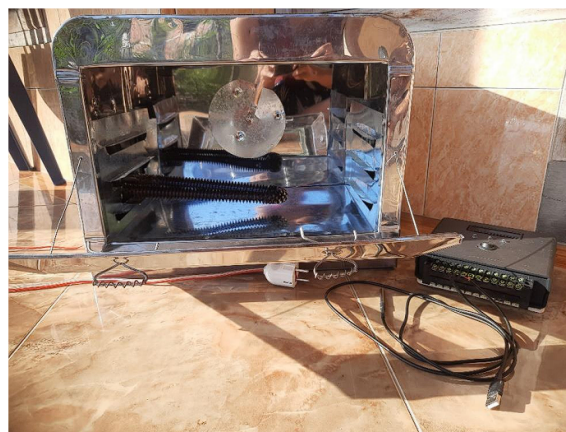
Gambar 1. Alat Pengering Maggot berbasis IoT
