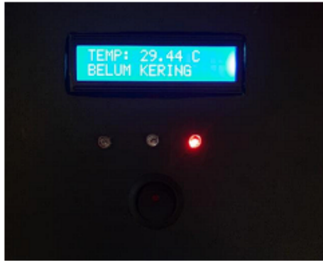
Gambar 4. Indikator Deteksi Suhu Belum Kering
