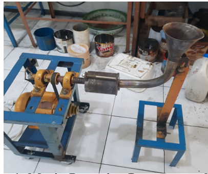
Gambar 1. Mesin Prototipe Pengecoran Sentrifugal
