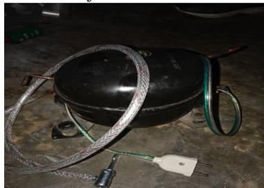
Gambar 1. Alat kompresor menggunakan mesin *freezer*
