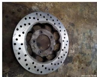
Gambar 3. Piringan cakram untuk pisau pemotong
