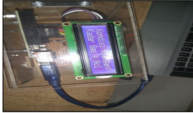
Gambar 9. Pengujian setelah gas terdeteksi LCD menampilkan kadar gas.
