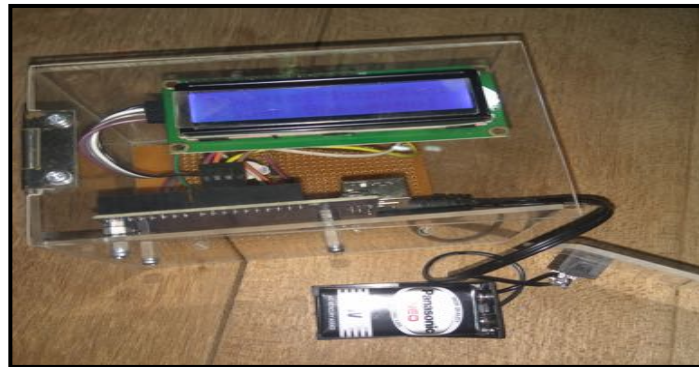
Gambar 6. Pengujian Arduino Uno dengan supply baterai
