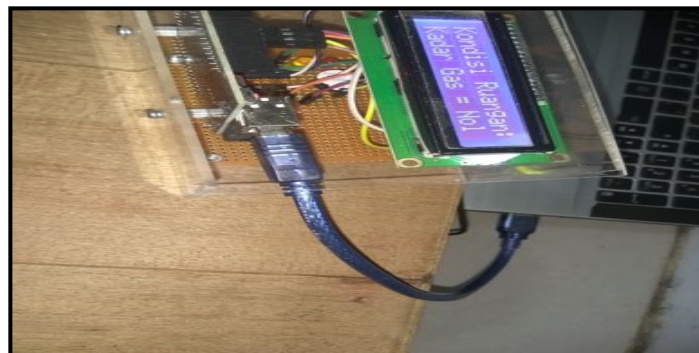
Gambar 7. Arduino Uno dihubungkan dengan Laptop
