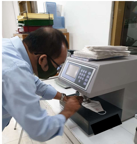
Gambar 4 Pengukuran Porositas Masker Kain Menggunakan Bekk Smoothness Tester
