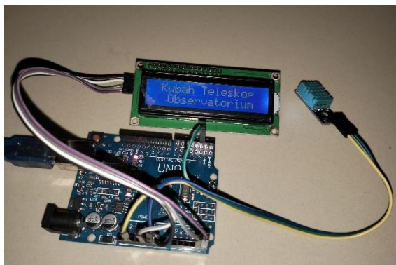
Gambar 15. Rangkaian Sistem Monitoring Suhu dan Kelembaban pada Arduino UNO
