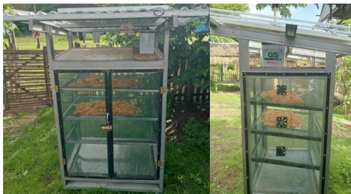
Gambar 3. Alat pengering rumput laut siap pakai dengan panel surya
