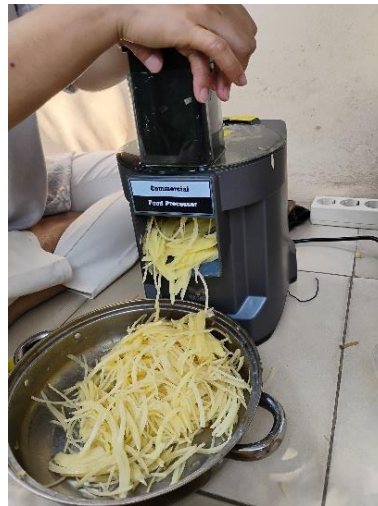
Gambar 3. Mesin pengiris singkong kapasitas 120 kg/jam
