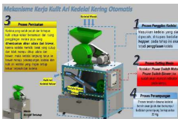
Gambar 5. Mekanisme Kerja Mesin pemisah Kulit Ari Kedelai Kering Otomatis
