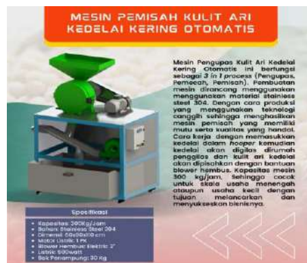
Gambar 1. Rancangan Mesin pemisah Kulit Ari Kedelai Otomatis
