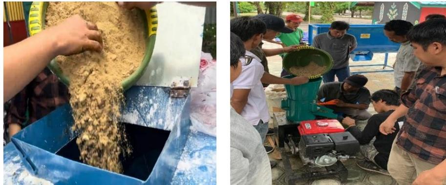
Gambar 10. Pencampuran bahan baku dengan alat mixer dan pencetakan pelet pakan ikan
