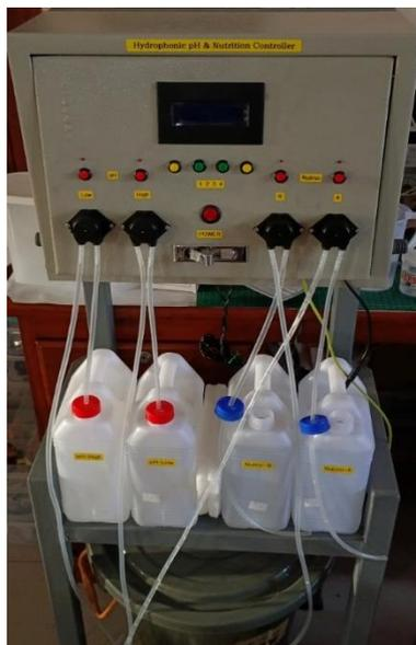
Gambar 1. Realisasi Sistem Kontrol Hidroponik untuk Kebun Hidroponik di Ponpes
