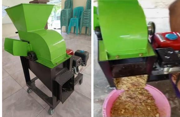
Gambar 4. Mesin *Shred-Chopper*
