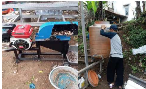
Gambar 5. Mesin pencacah sampah organik dan Tandon air untuk budi daya Maggot
