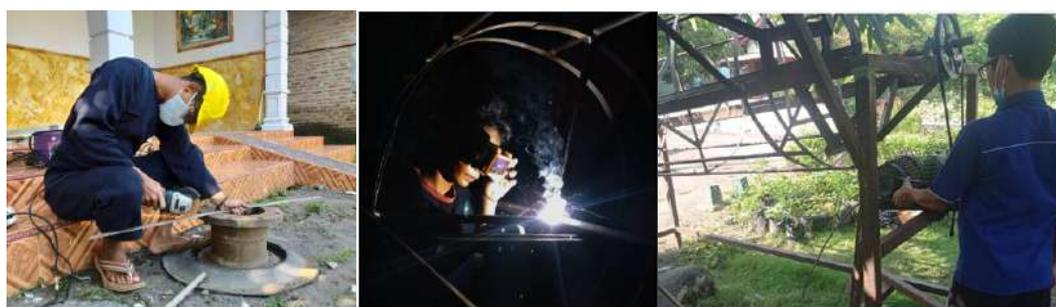
Gambar 6. Proses pembuatan mesin pengayak arang tempurung
