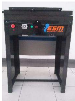
Gambar 9. Alat Pemasak Garam “Electrical Salt Machine”
