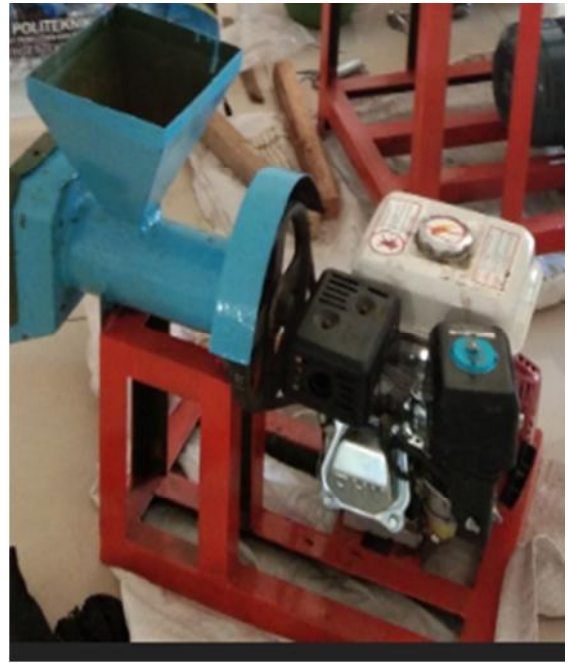
Gambar 5. Granulator ukuran besar kapasitas 150kg/jam motor 2,5 PK
