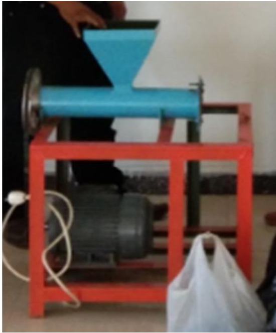
Gambar 4. Granulator dengan kapasitas 60 kg/ jam penggerak motor 7,5 HP
