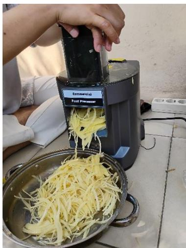
Gambar 3. Mesin pengiris singkong kapasitas 120 kg/jam
