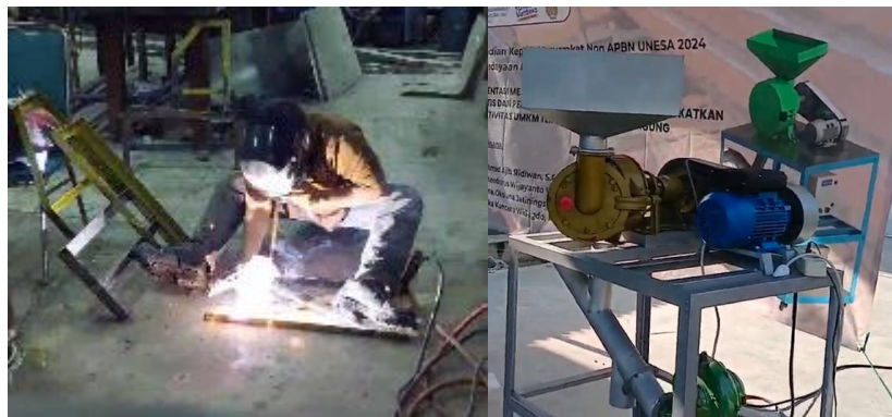
Gambar 2. Proses Manufaktur Mesin dan Mesin Pemisah Kulit Ari Kedelai Kering
