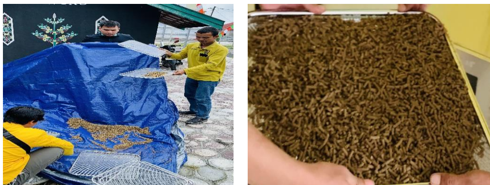
Gambar 11. Proses pengeringan pelet dan pelet pakan ikan yang dihasilkan
