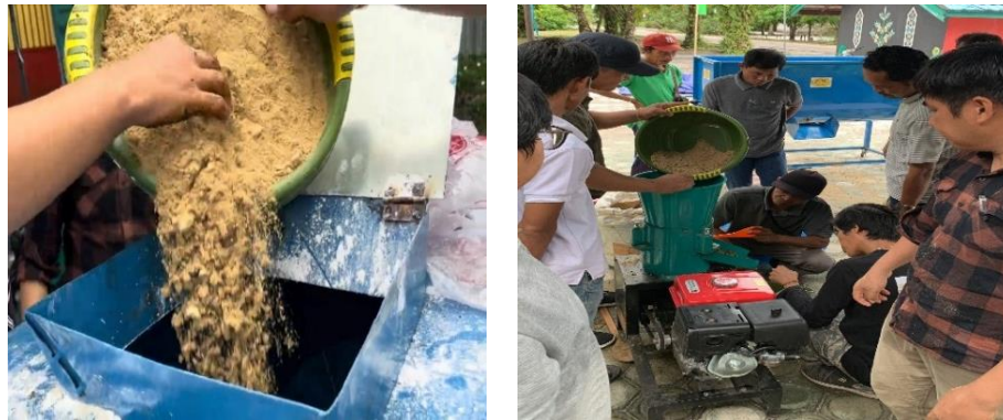
Gambar 10. Pencampuran bahan baku dengan alat mixer dan pencetakan pelet pakan ikan
