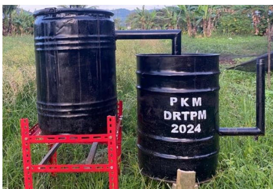
Gambar 2. Alat Pirolisis Asap Cair
