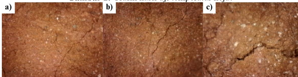
Gambar 3. Morfologi hasil uji makro (a) temperatur 700 °C pada siklus 5, (b) temperatur 800 °C pada siklus 5, dan (c) temperatur 900 °C pada siklus 4
