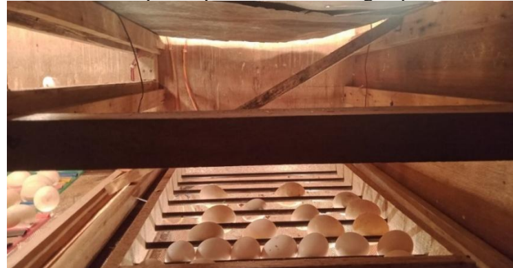
Gambar 5. Tampak depan inkubator dengan ditutupi plat seng dibawah lampu
