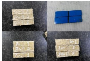
Gambar 3. menunjukkan bentuk dan dimensi yang digunakan pada uji impact metode charpy
