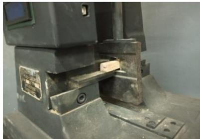
Gambar 4. Pengujian Impak
