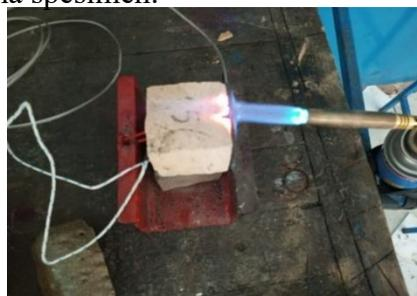
Gambar 5. Pengujian Konduktivitas Panas
