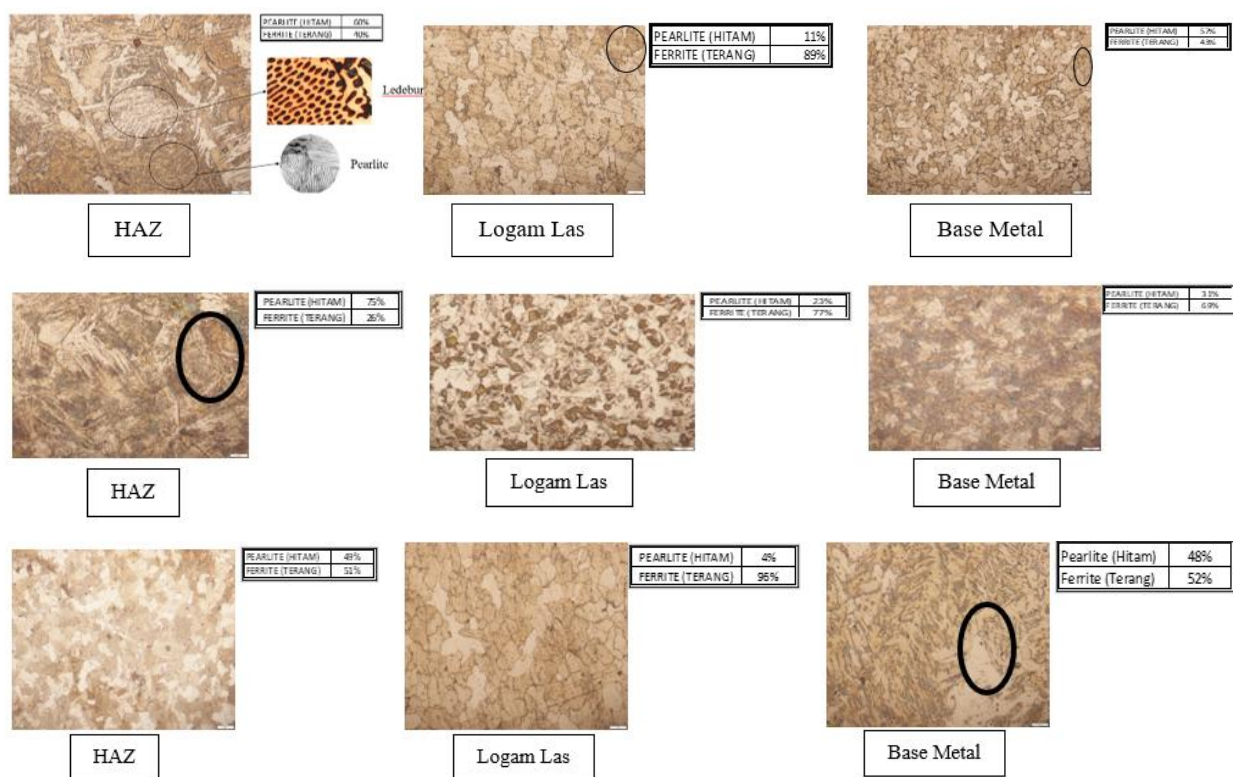
Gambar 4. Hasil uji mikrostruktur media pendingin oli setelah pengelasan
