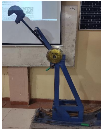
Gambar 4. Mesin Uji Impak Charpy
