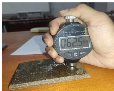
Gambar 3. Alat Uji Durometer Shore D
