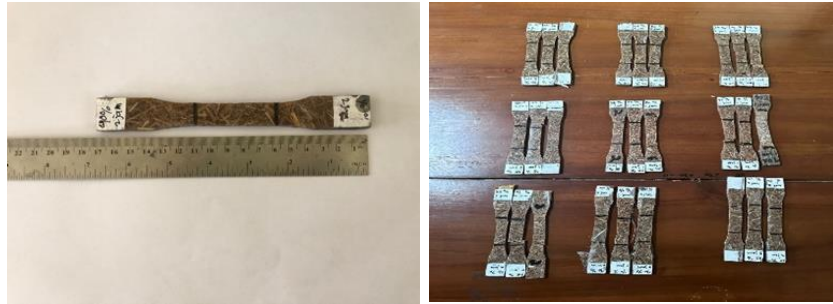
Gambar 1. Spesimen komposit serat eceng gondok.
