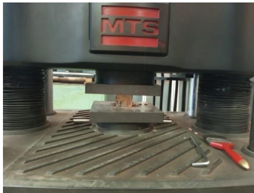
Gambar 2. Uji Kuat Tekan Bata menggunakan Mesin MTS Criterion M 64
