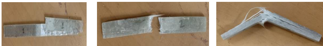
Gambar 4. Gambar patahan uji impact 4lapis, 8 lapis, dan 12 lapis
