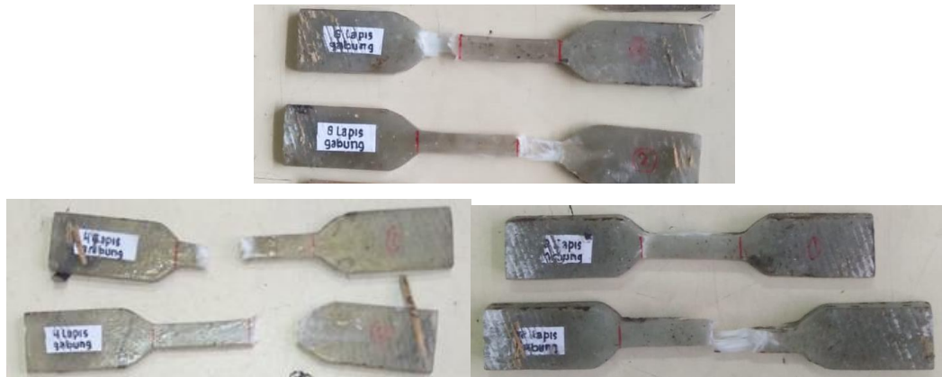
Gambar 5. Gambar komposit setelah diuji kekuatan tarik
