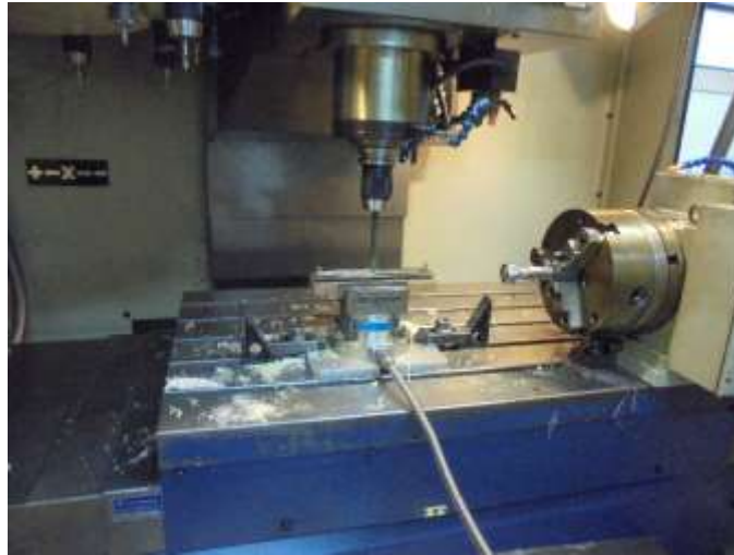
Gambar 2. Proses Penggurdian Komposit KFRP
