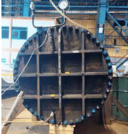
Gambar 3. Peralatan telah terpasang pada tubesheet hydrotest
