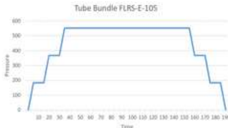
Gambar 6. Menunjukkan Langkah Timing Pengukuran Tekanan Pengujian Hydrostatic Test Tidak Kurang dari 1.5 Kali Tekanan Nominal
