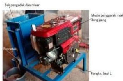
Gambar 2. Mesin Cetak Pelet Pakan Ternak dari bahan baku Onggok
