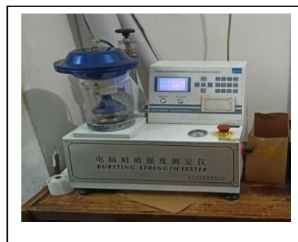
Gambar 12. Alat untuk pengujian bursting strength .
