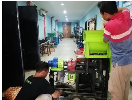
Gambar 3. Pengujian Mesin Pencetak Pelet
