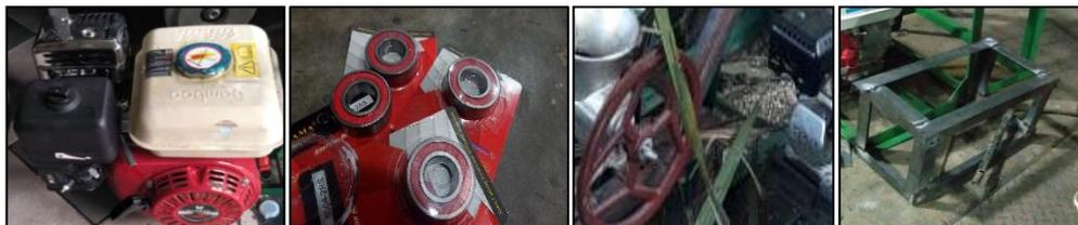
gambar 7. komponen-komponen utama smart kapsul. (a) motor bensin, (b) *bearing*, (c) *pulley*, (d) kerangka dudukan
